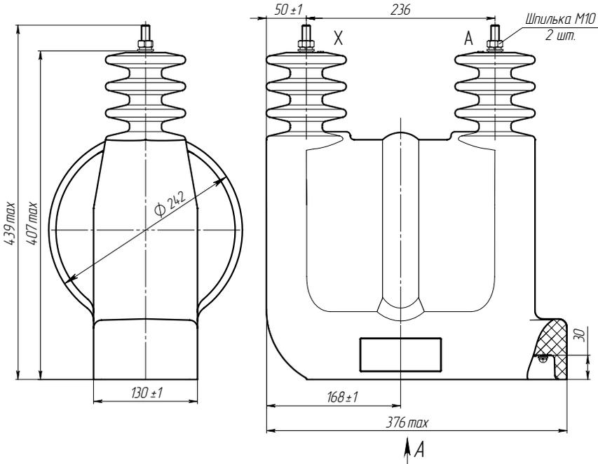
Рис. 1. Общий вид трансформаторов ОЛ
