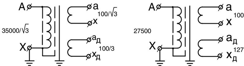
Рис. 2. Схемы трансформаторов
