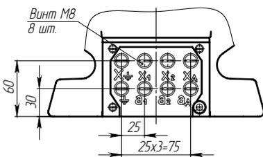
Рис. 3. Клеммник трансформаторов
