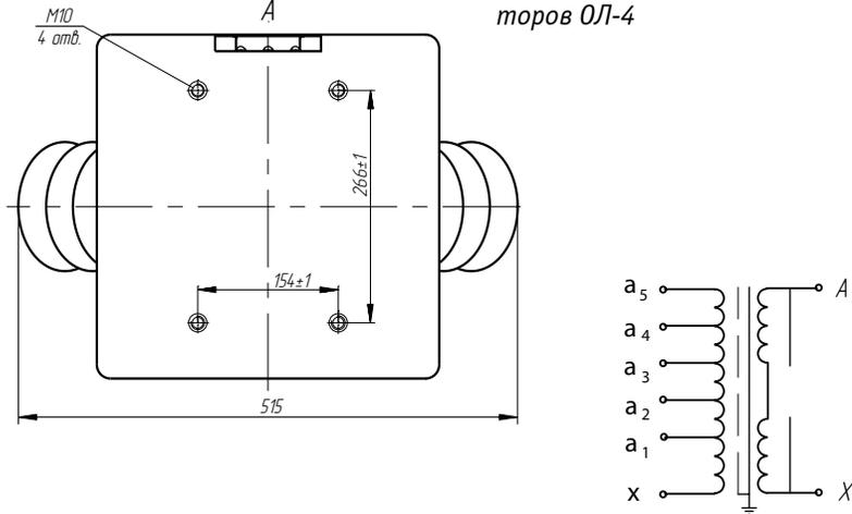
Рис. 2. Принципиальная электрическая схема трансформаторов ОЛ-4
