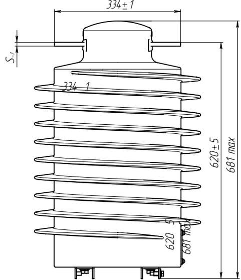
Рис. 1. Общий вид трансформаторов ТОЛ-35 III-7.2
