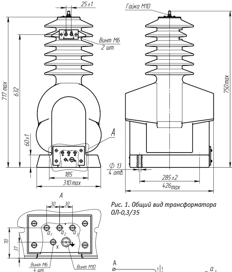
Рис. 1. Общий вид трансформатора
