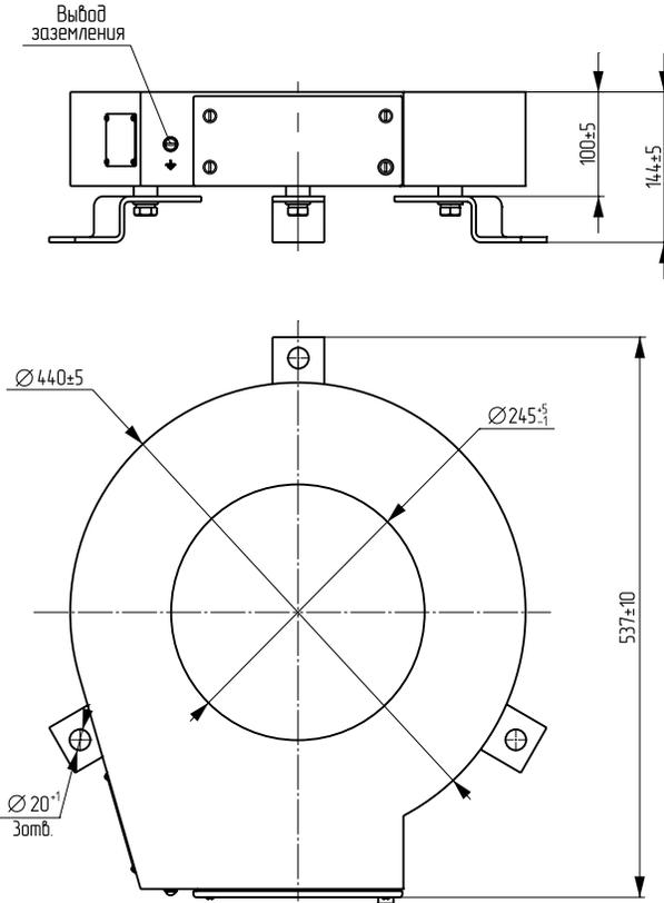
Рис. 1. Габаритные, установочные и присоединительные размеры трансформатора ТВ-35-IX
