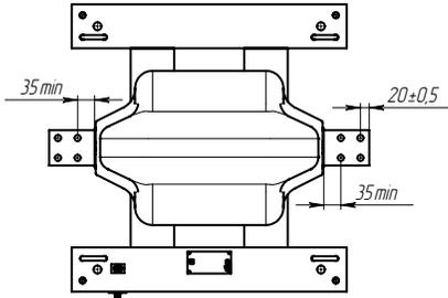
Рис. 2. Общий вид трансформаторов ТОЛ-35
