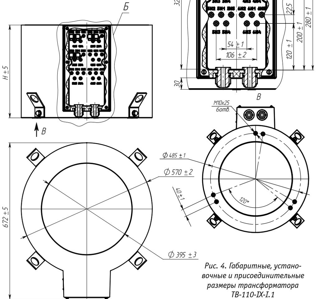
Рис. 4. Габаритные, установочные и присоединительные размеры трансформатора ТВ-110-IX-1.1
