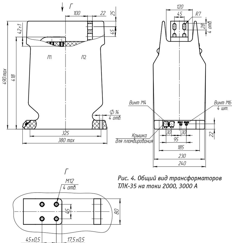
Рис. 4. Общий вид трансформаторов
