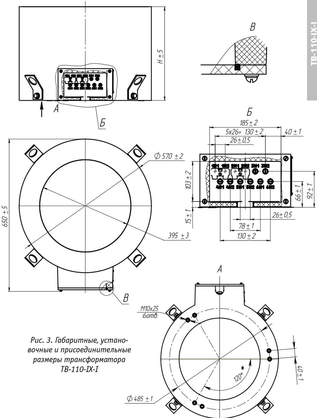
Рис. 3. Габаритные, установочные и присоединительные размеры трансформатора TB-110-IX-1
