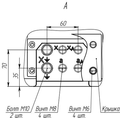
Рис. 4. Клеммник трансформатора
