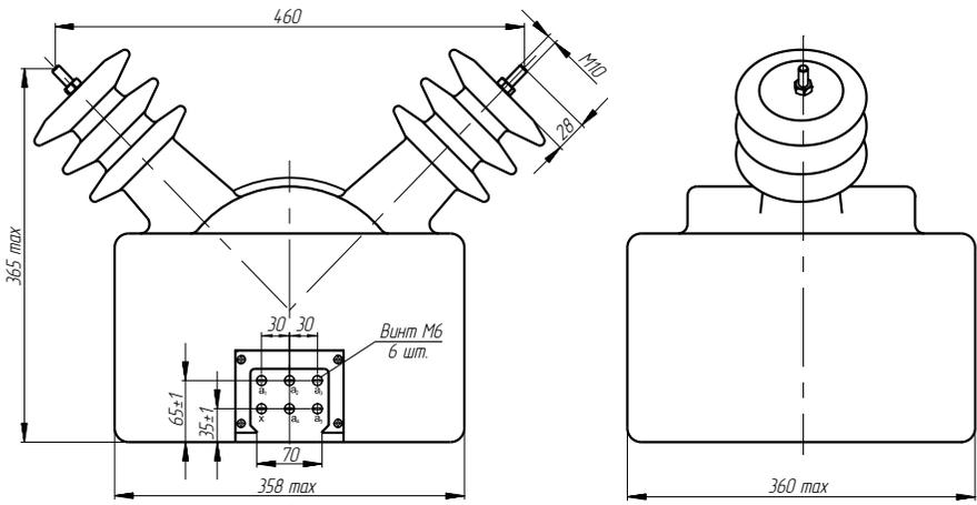
Рис. 1. Общий вид трансформаторов ОЛ-2,5
