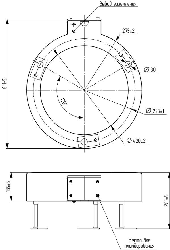
Рис. 2. Габаритные, установочные и присоединительные размеры трансформатора ТВ-110-IX
