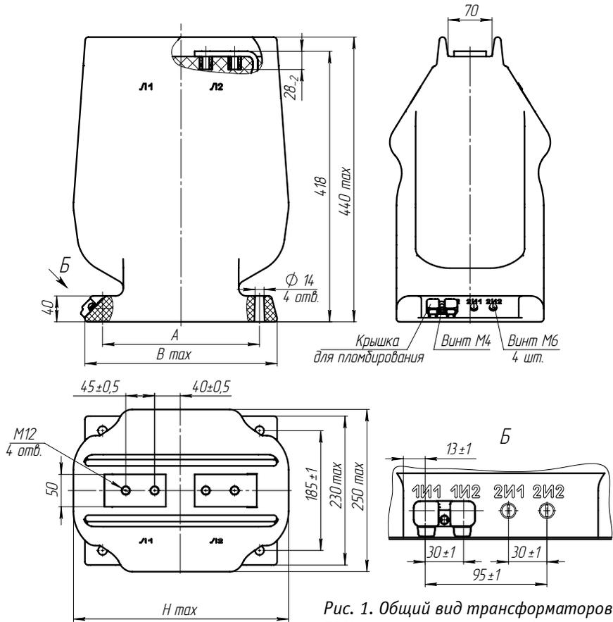
Рис. 1. Общий вид трансформаторов ТЛК-35 на токи 150–1500 А
