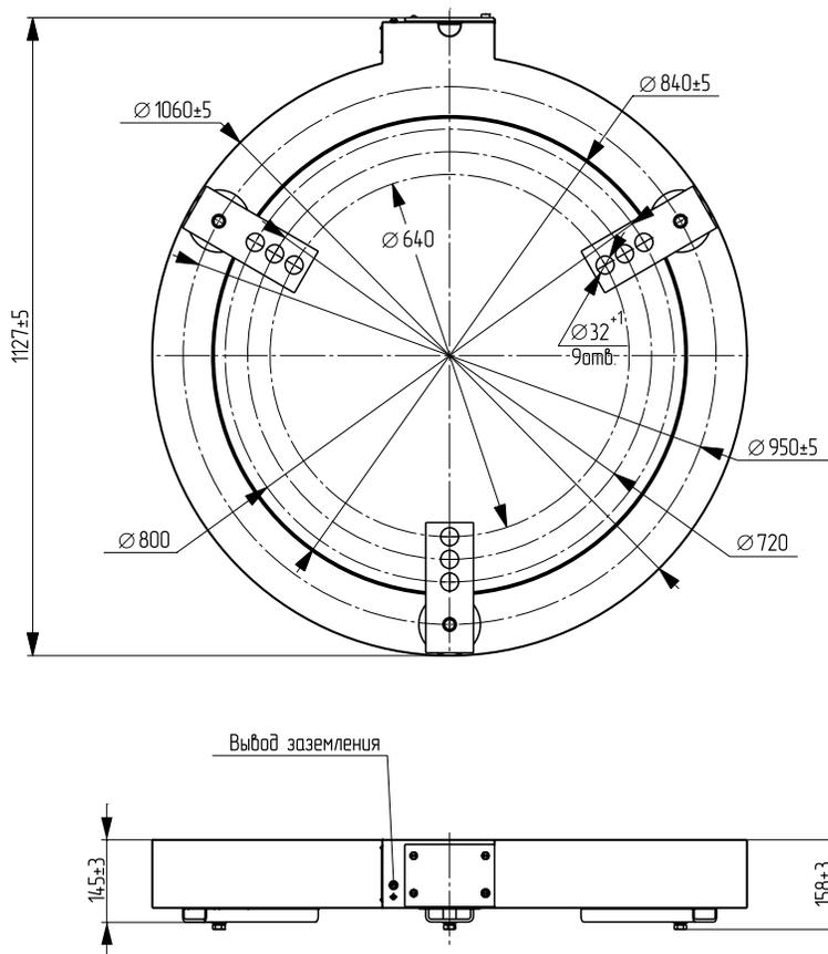
Рис. 4. Габаритные, установочные и присоединительные размеры трансформатора ТВ-220-IX
